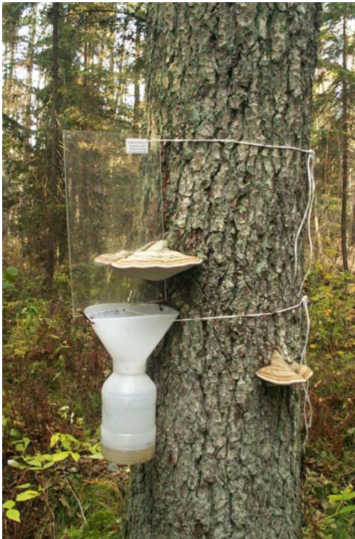
Fot. 1. Pułapka typu „Fomes” zawieszona na olszy ( Alnus sp.), na owocniku hubiaka pospolitego Fomes fomentarius (L.: Fr.) Fr. (powierzchnia nr 13) (fot. A. Rutkiewicz) Phot. 1. “Fomes” type of window trap hung on alder ( Alnus sp.) on fruiting body of the tinder conk Fomes fomentarius (L.: Fr.) Fr. (plot no. 13)
