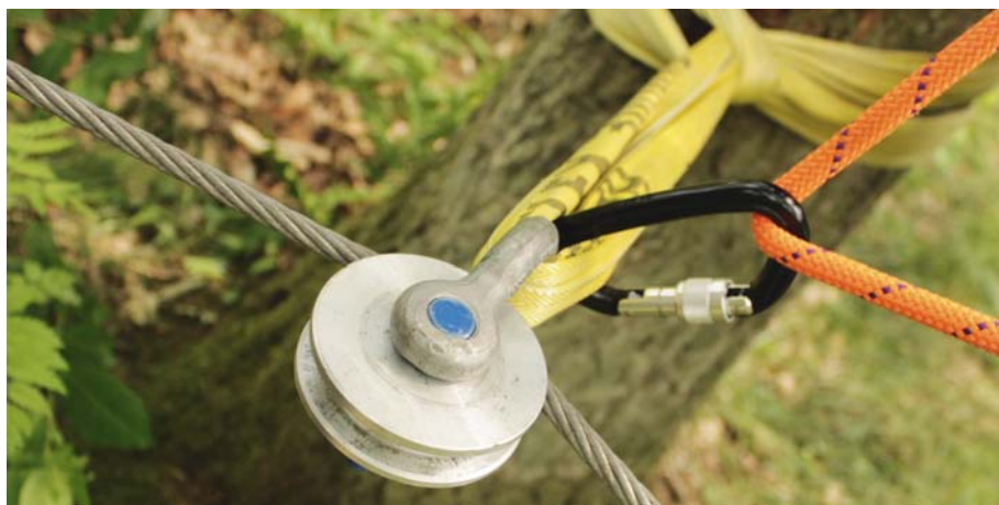
Fot. 4. Mocowanie elementu mobilnego niskiego parku linowego Photo 4. Element of mobile Low Ropes Course
