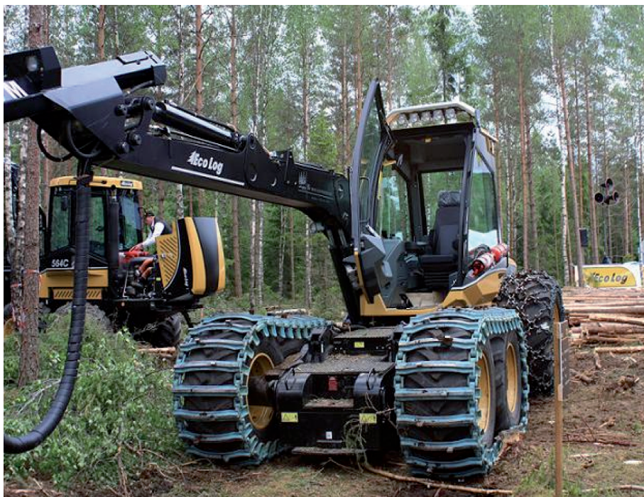
Fot. 2. Harwester z gaśienicą na osi przedniej typu bogie. Targi ELMIA WOOD 2009 (fot. L. Lewaszkiewicz)
