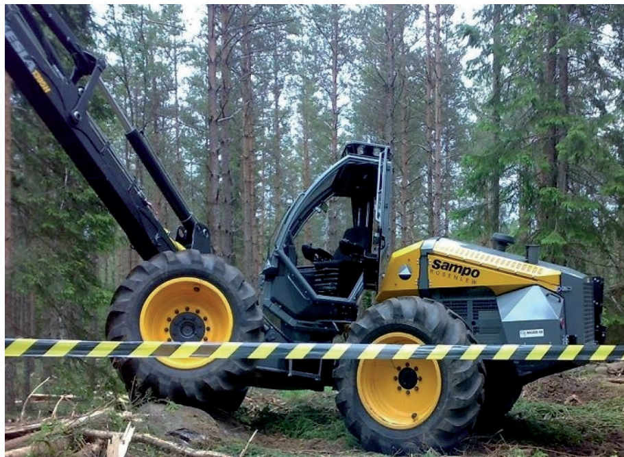
Fot. 3. Układ jezdny kołowy z dwoma osiami sztywnymi. Targi ELMIA WOOD 200 (fot. Ł. Lewaszkiewicz)
