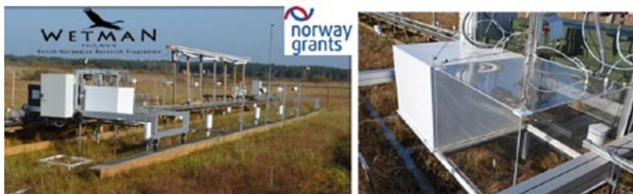
Ryc. 4. Prototypowa samojezdna platforma pomiarowa do automatycznych pomiarów strumieni \text{CO}_2 i \text{CH}_4 na torfowisku w Rzecinie zbudowana w ramach projektu Polsko-Norweskiego WETMAN (Pol-Nor/203258/31/2013)
