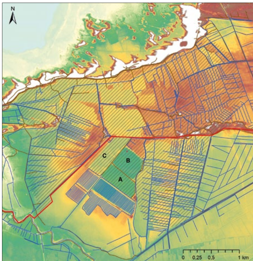
Ryc. 4. Sieć melioracyjna i zbiorniki poeksploatacyjne (A-C) na torfowisku Wielkie Bagno na tle numerycznego modelu terenu ISOK. Skośnym szrafem zaznaczono obszar torfowiska objęty projektem, czerwoną linią – granice Słowińskiego Parku Narodowego (źródła danych: Słowiński Park Narodowy, geoportal.gov.pl ) Fig. 4. The drainage infrastructure and post-exploitation water bodies (A-C) on the Wielkie Bagno peatland in relation to the Digital Terrain Model ISOK (data source: Słowiński National Park, geoportal.gov.pl ). The area of the peatland within the project has been marked with a diagonal hachure colour, with a red line – borders of the Słowiński National Park
