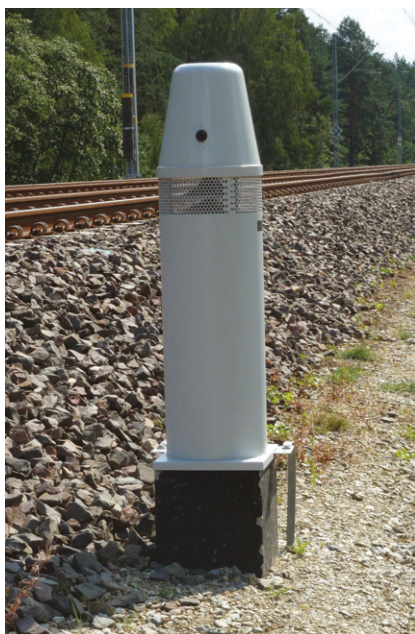
Fot. 3. Dźwiękowe urządzenie do odstraszenia zwierząt od torów kolejowych (fot. M. Stolarski) Photo 3. Acoustic animal deterring device for railway lines (photo. M. Stolarski)
