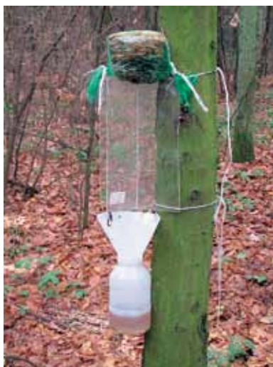
Fot. 4. Konstrukcja pułapki samolownej w wariantcie I (fot. J. Piętka)
