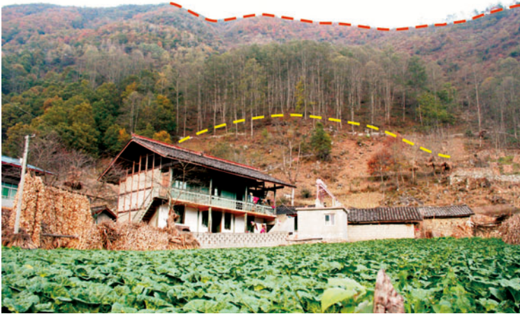
Fot. 2. Badane osuwisko wraz z budynkami położonymi u jego podnóża, czerwona przerywana linia wyznacza niszę osuwiskową, żółta linia wyznacza wybrzuszenie jeżora osuwiskowego Photo 2. Studied landslide with buildings located at its foothills, red dotted line showing landslide niche, yellow dotted line showing landslide tongue
