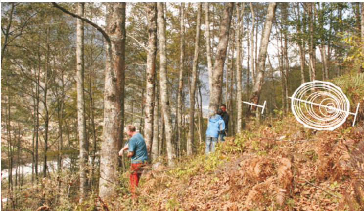
Fot. 3. Pobór prób z olsz nepalskich rosnących na badanym osuwisku oraz schemat dekoncentryczności przyrostów w pniu olszy pochylonym dostokowo przez osuwanie Photo 3. Taking samples from Nepalese alders growing on the landslide slope under study and the scheme of eccentric tree rings in stem of alders tilted upslope by landsliding
