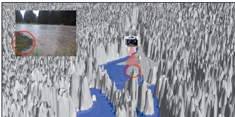
Ryc. 10. Porównanie stanu wody na symulacji ze zdjęciem archiwalnym przedstawiającym faktyczny stan powodziowy
