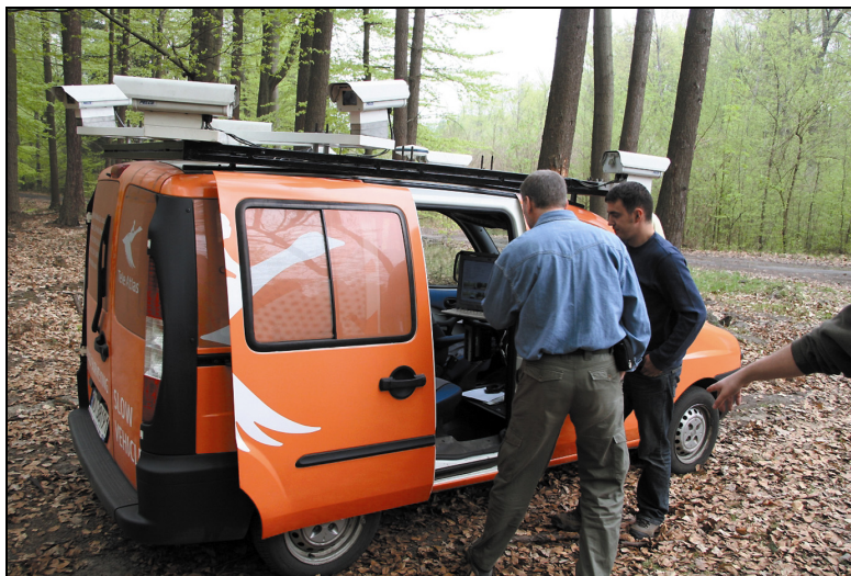
Fot. 2. Samochód wykorzystywany do inwentaryzacji dróg metodą MMS.
